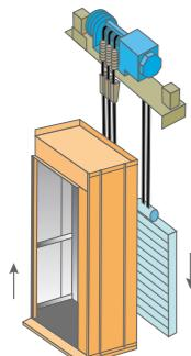
En un ascensor la cabina está unida a un contrapeso a través de una polea. Cuando el contrapeso baja, la cabina sube, y cuando el contrapeso sube, la cabina baja.
