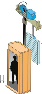
Si la cabina baja cargada, ésta pesa más que el contrapeso, por ello baja por efecto de la gravedad, de forma controlada, generando energía.
